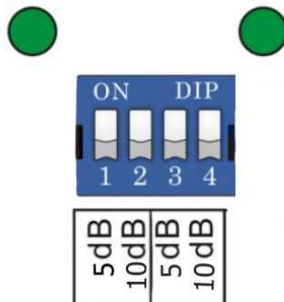
Усиление возможно изменять с помощью переключателей на фронтальной панели. При необходимости сначала отрегулируйте D/L (переключатели 1-2) в зависимости от входящего сигнала, а затем U/L (переключатели 3-4) в зависимости от D/L. Переключатели по умолчанию выключены.
